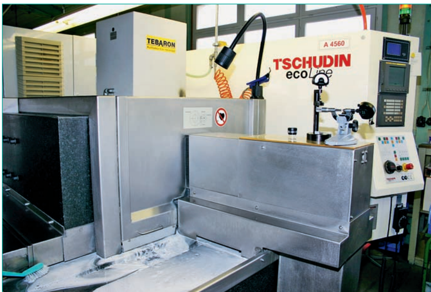
Die Centerless-Schleifmaschine «Tschudin Ecoline» bewirkte bei der Veith AG in Diessenhofen einen Sprung nach vorne hinsichtlich Qualität und Produktivität.
