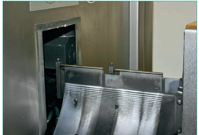
Dank der guten Zugänglichkeit lässt sich das Be- und Entladen der Schleifmaschine einfach automatisieren.
