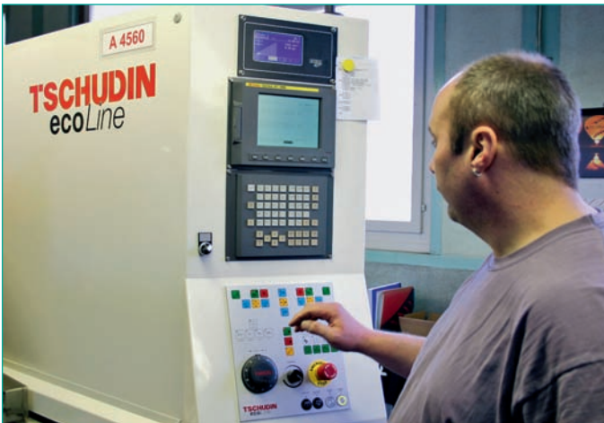
Gesteuert wird die «Tschudin Ecoline» von der Fanuc CNC-Steuerung der Serie 21i-MB. Maschinenbediener Thomas Dippelhofer kommt damit bestens zurecht.
